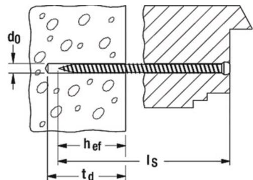
Profondeur d'ancrage effective  $h_{ef}$
