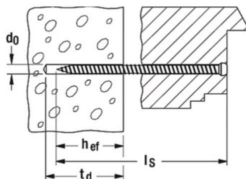
Profondeur d'ancrage effective  $h_{ef}$
