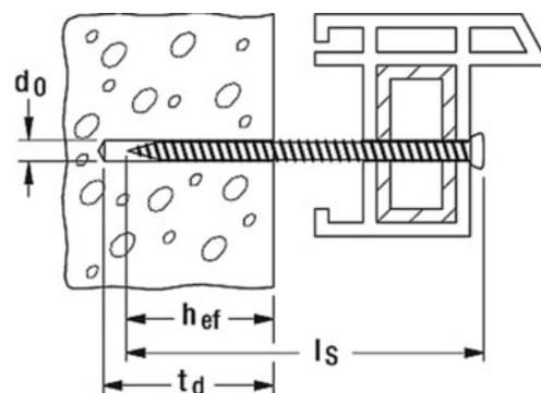
Profondeur d'ancrage effective  $h_{ef}$
