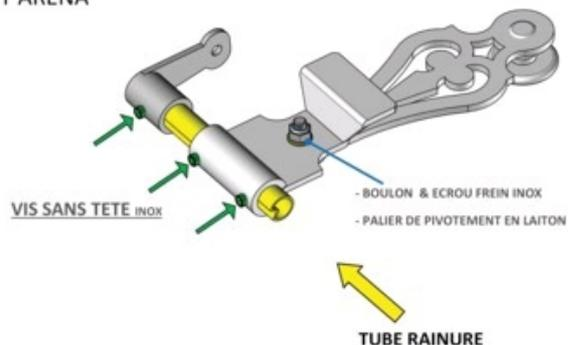
Vis pointeau (sans tête) assure le blocage et l'alignement de la poignée et des embouts sur le tube rainuré
