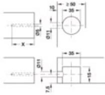
La mesure X dépend de la vis d'assemblage
