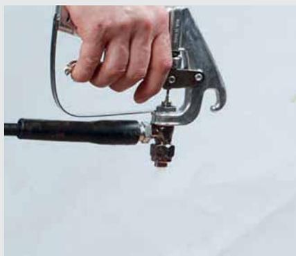
Pulvériser jusqu'à obtention d'un jet régulier de colle pour la remise en service.
