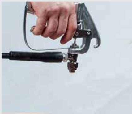
Vider complètement le flexible jusqu'à ce qu'il n'en sorte plus de colle ni de gaz propulseur.
