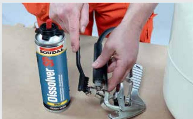
Pulvériser suffisamment de dissolvant sur la buse et frotter avec une brosse douce (répéter si nécessaire).
