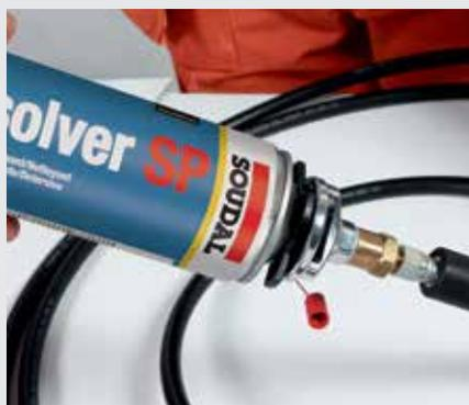
Connecter le Cleaning Adaptor sur le Dissolver SP\* (le flexible se remplit directement de solvant).
