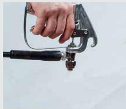
Dès que vous pouvez pulvériser suffisamment de solvant, le flexible est propre. Laisser agir le solvant 24h si le flexible est complètement bouché.
