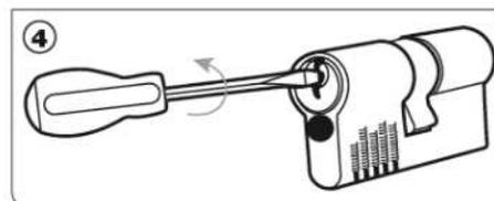
Utilisez un tournevis plat pour faire tourner le rotor dans le sens de l'ouverture.
