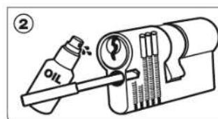
Percez en lubrifiant, retirez les goupilles au fur et à mesure de leur dégagement avec un tournevis fin.
