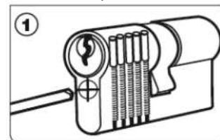
Positionnez le foret dans le bâti juste sous le rotor à un demi mm. Prenez soin de ne pas abîmer le rotor.
