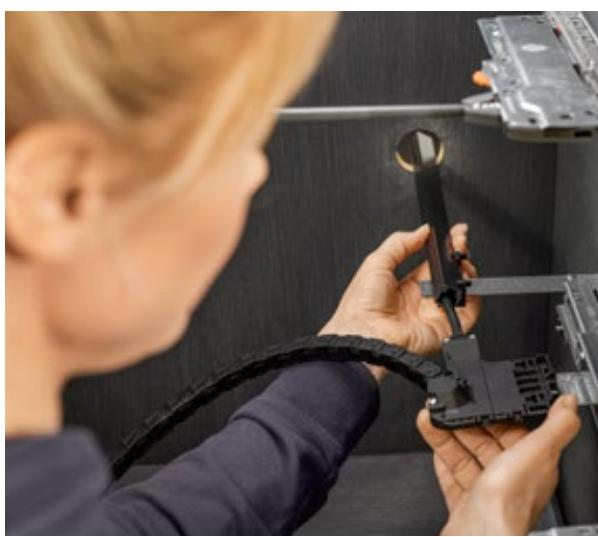
④ De même, il suffit de clipser la goulotte pour câble dans le support approprié.
