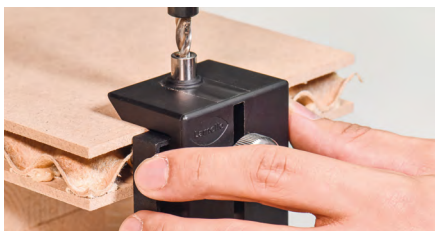
Percer un trou d'accès de 6 mm
