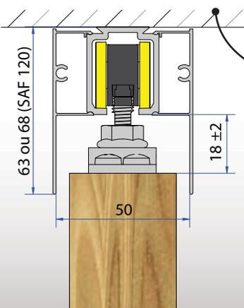
Montage fixation au plafond avec platine encastrée 11036
