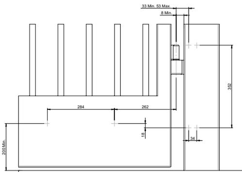
Dimensions d'installation pour montage en bas (côté tirant)
