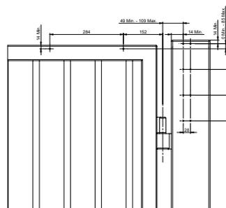
Dimensions d'installation avec plaque équerre de montage AC633 pour montage sur pilier (côté poussant)
