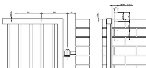
Dimensions d'installation avec plaque équerre de montage AC633 pour montage sur mur (côté tirant)
