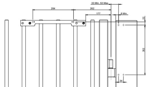
Dimensions d'installation avec plaques de montage de rail coulissant AC632 pour montage standard (côté tirant)
