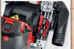
Les butées de profondeur « 1 » et « 2 » permettent de régler deux profondeurs de perçage. Elles sont présélectionnées grâce au bouton rotatif. Le bouton rotatif permet, par ailleurs, de régler le changement d'outil qui bloque automatiquement l'interrupteur de mise en marche.
