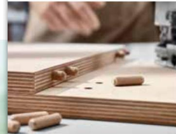
Les perçages espacés de 32mm sont un grand classique chez les professionnels. Si un autre système de tourillons est utilisé, il faut alors toujours recourir à un appareil supplémentaire. La tourillonneuse double DDF 40 permet de positionner également des rangées de trous et des alésages de ferrures à 32 mm - et de monter ainsi un meuble entier.
