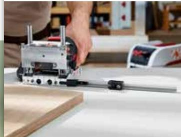
Le système de butée breveté avec broches et butée à ressort dans la plaque de base a été simplement adapté pour convenir à la nouvelle butée latérale SA 320. Il est ainsi possible de positionner de manière reproductible et sans race des paires de trous plus éloignées du bord de référence.
