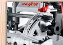
La butée pivotante est guidée des deux côtés et bloquée de manière centrale par une seule vis de réglage. Elle peut pivoter en continu de 0 à 90 degrés pour les assemblages en onglet. Des crans sont prévus à 22,5°, 45° et 67,5°.
