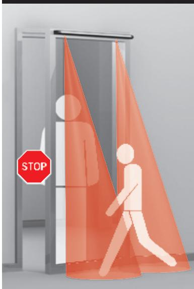
Les sensors de sécurité DORMA IRS-2 sont des détecteurs à bi-technologie active permettant de détecter tout ce qui se trouve ou se déplace (objets ou personnes) dans la zone de déplacement du vantail. Côté opposé aux paumelles, le sensor de sécurité peut-être utilisé comme détection d'ouverture.
