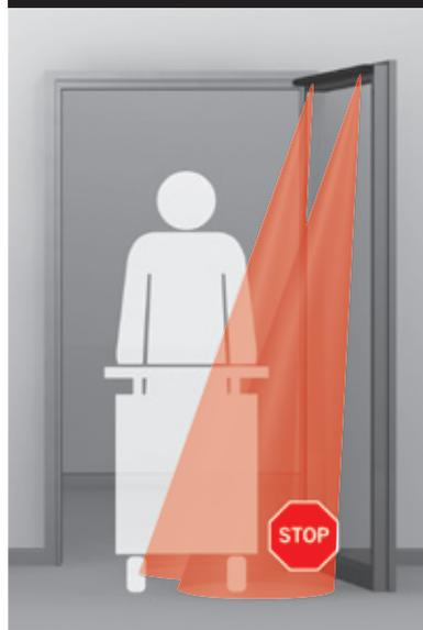
sécurité détecte une présence. Dès que la temporisation de maintien à l'ouverture est écoulee, la porte se referme. Les sensors de sécurité à bi-technologie active DORMA sont disponibles dans différentes longueurs et peuvent être commandés dans une couleur spéciale selon palette RAL.
