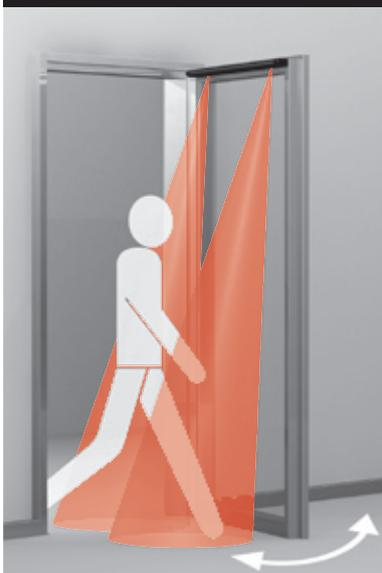
Durant le cycle de fermeture, si le sensor de sécurité détecte une présence, le mouvement de la porte est inversé et celle-ci s'ouvre à nouveau. La temporisation de maintien à l'ouverture est relancée. Côté paumelles, durant le cycle d'ouverture, le mouvement de la porte est stoppé lorsque le sensor de
