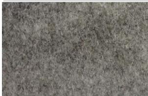
Allprotect (Flex) se compose d'un non tissé résistant au toucher doux équipé d'un dos imperméable et fortement adhérent. Il a été développé pour des utilisations de poses critiques et la plupart des surfaces courantes. \*Grâce à sa grande force d'adhérence, le produit peut se positionner à la verticale comme à l'horizontale.
