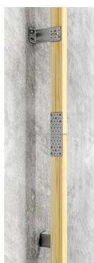
Aboutage de chevrons
