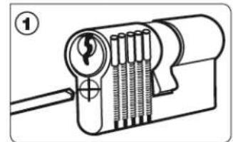
Positionnez le foret dans le bâti juste sous le rotor à un demi mm. Prenez soin de ne pas abîmer le rotor.
