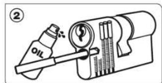
Percez en lubrifiant, retirez les goupilles au fur et à mesure de leur dégagement avec un tournevis fin.
