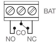
Relais représenté en mode défaut batterie ou tension seuil bas (21-22V DC) ou absence batterie.
