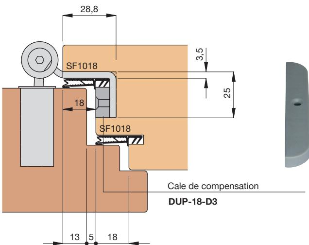
**Recouvrement de 18 mm -
