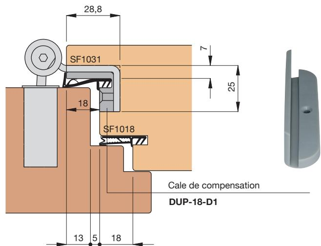
**Recouvrement de 18 mm -
