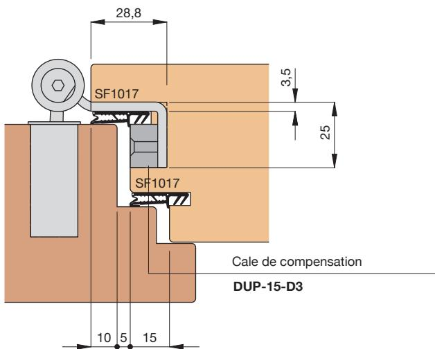
**Recouvrement de 15 mm -
