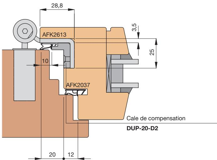
**Recouvrement de 20 mm - Joint de recouvrement 10 mm - 20-D2
