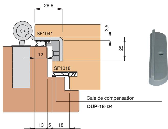
**Recouvrement de 18 mm -
