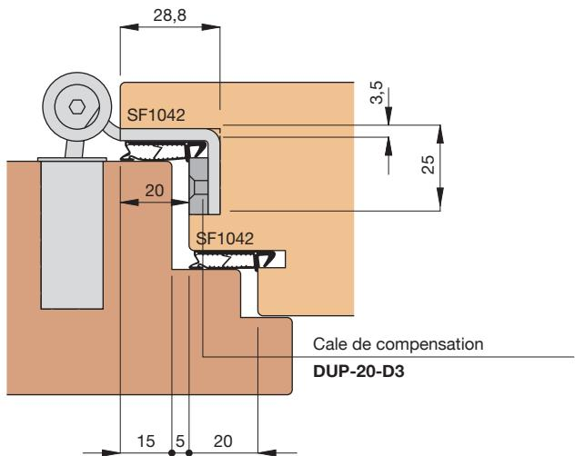
**Recouvrement de 20 mm -
