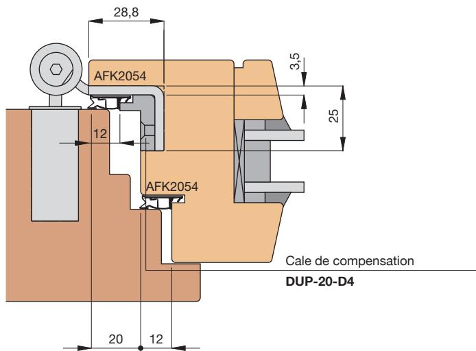
**Recouvrement de 20 mm - Joint de recouvrement 12 mm - 20-D4
