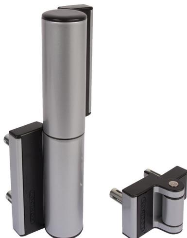
Charnière 180° avec rappel de fermeture hydraulique pour des portes jusqu'à 75kg. La vitesse de fermeture et l'a-coup final sont réglables après installation. Installation simple et rapide avec fixations Quick-Fix. Combinaison avec charnière Puma. Conforme aux normes Handicapé.
