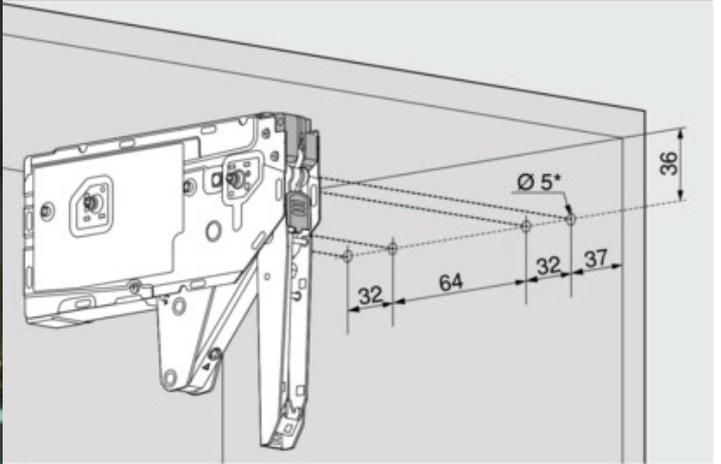
\* Profondeur de perçage 11.5 mm
