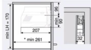
\* Min. 261 mm avec ferrures de suspension visibles
