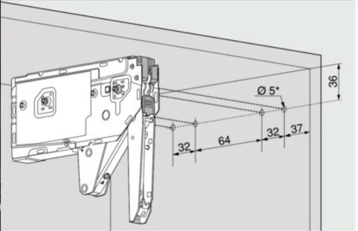
\* Profondeur de perçage 11.5 mm
