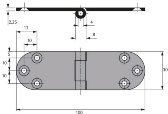
Fixation avec vis à bois à tête fraisée  $\varnothing$  3,5 DIN 97
